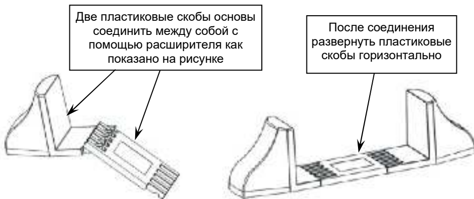
Рисунок 3 – Сборка пластиковых основ и расширителя для вертикальной установки ББ с ИБП
