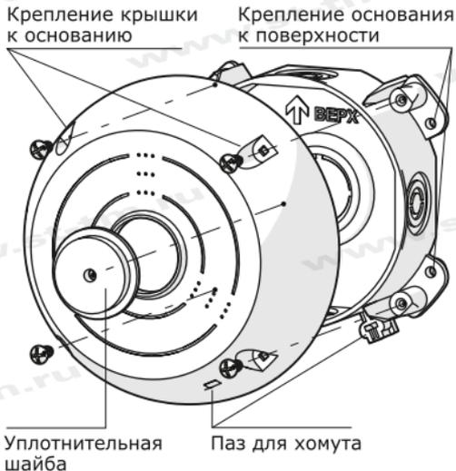
2) Закрепите основание монтажной коробки на поверхность, используя дюбели и саморезы.
