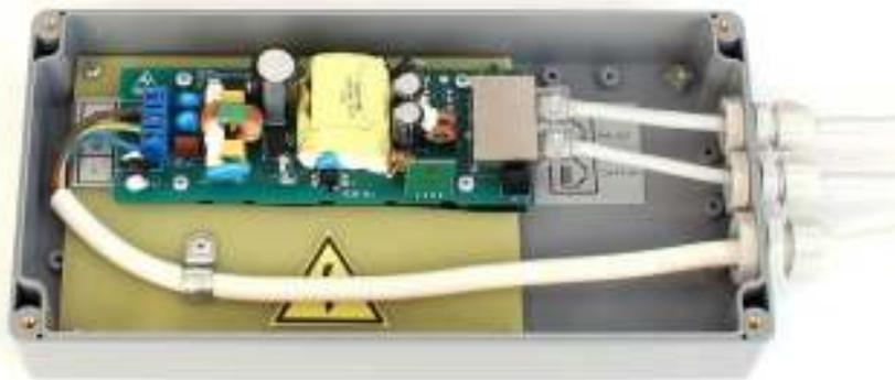
Рис. 3 Пример инжектора с подключенными кабелями
