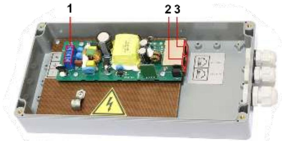
Рис. 2 Уличный инжектор Midspan-1/30WG, разъёмы
