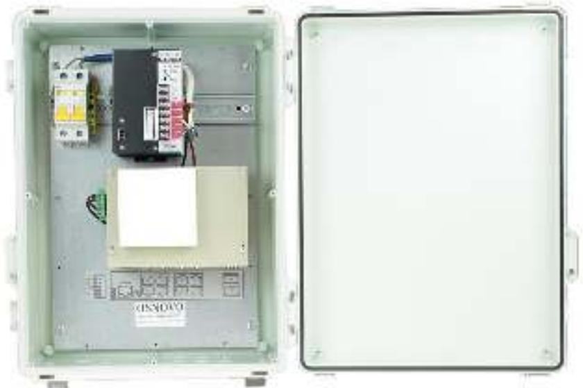
Рис.2 Уличный коммутатор SW-80802-WL(port 90W), внешний вид внутри
