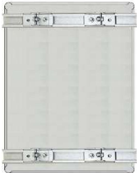
4. Планки обеспечивают возможность крепления коммутатора на стену и другие плоские поверхности. Для крепления на столб присоединить к планкам крепежные зубчатые элементы треугольной формы (крепежные элементы вдвигаются внутрь планок).
