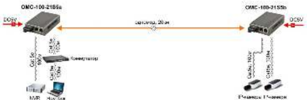
Рис. 7 Схема подключения медиаконвертеров OMC-100-21S5a (OMC-100-21S5b)
