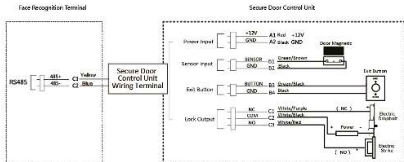
**Примечание.** Модуль безопасности необходимо подключать к внешнему источнику питания отдельно. Рекомендуемые параметры внешнего источника питания составляют 12 В, 0.5 А.
