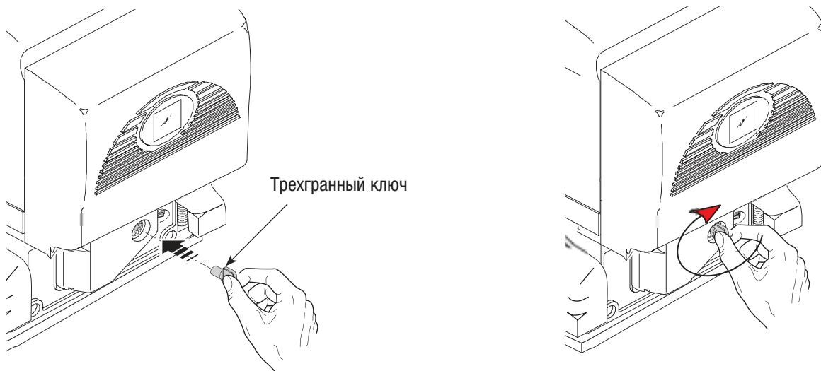
.... Откройте дверцу и поверните ручку разблокировки против часовой стрелки.
