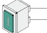
**Ключ-выключатель и/или кнопка управления (НР контакт)** - Команды открывания и закрывания створки - При нажатии на кнопку или повороте ключа селектора ворота меняют направление движения или останавливаются, в зависимости от установленного с помощью микропереключателей режима работы (смотрите выбор режимов работы, микропереключатели 2 и 3).
