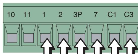
**Кнопка "стоп" (НЗ контакт)** - Кнопка остановки движения створки, исключающая цикл автоматического закрывания; для возобновления движения необходимо нажать на соответствующую кнопку кодонаборной клавиатуры или брелока-передатчика.
