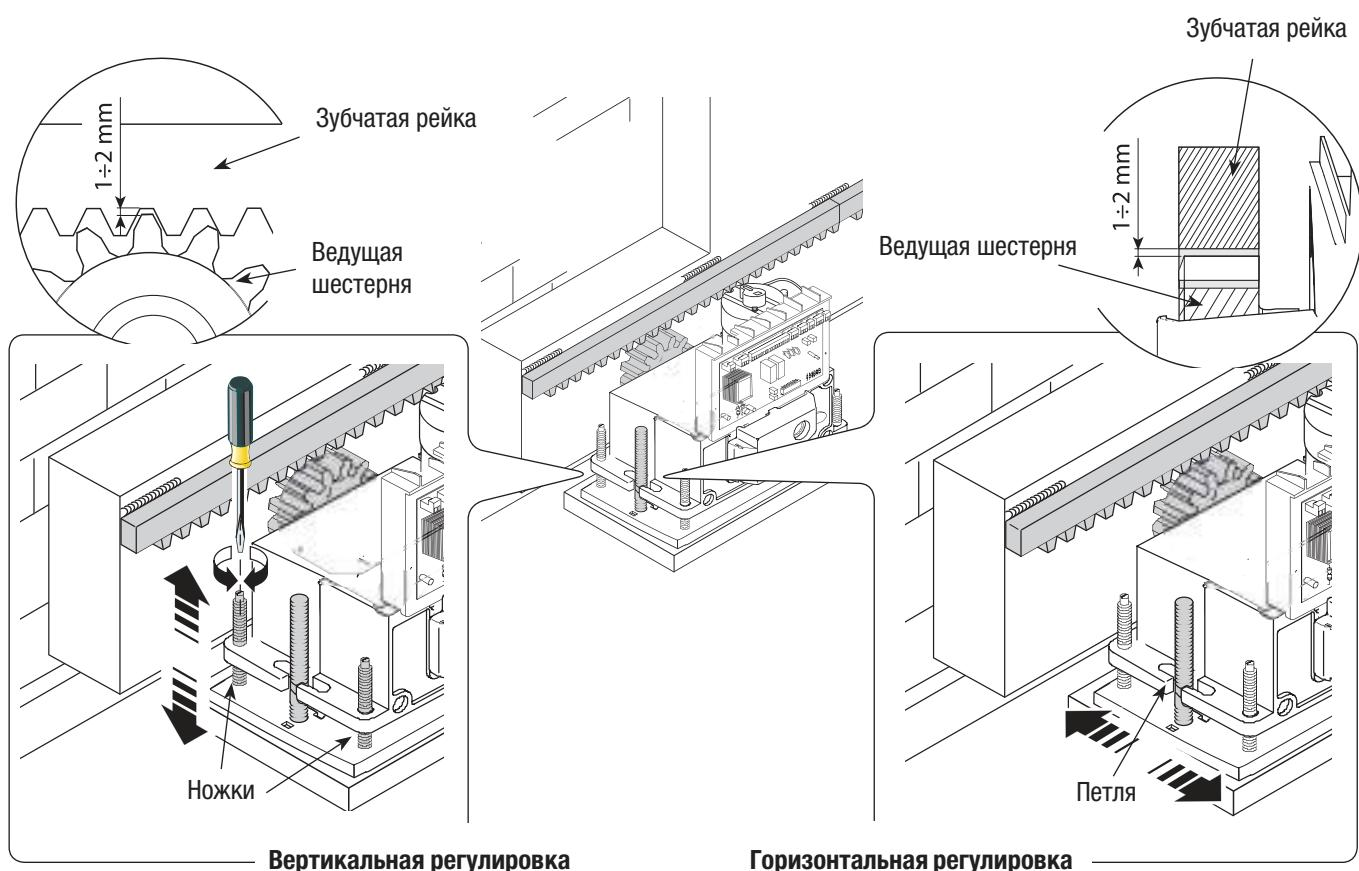
По окончании процесса регулировки зафиксируйте привод с помощью пластин и гаек. Крышка платы управления устанавливается и фиксируется после завершения всех работ по регулировке и настройке электронной платы.
