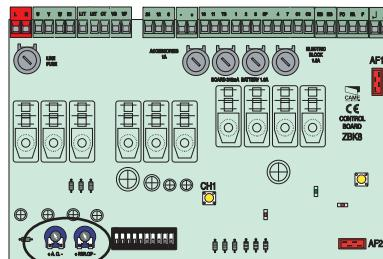
**Регулировка А.С.Т. =** Время автоматического закрывания. Регулирует время ожидания ворот в открытом положении; по истечении этого времени ворота автоматически закрываются. Время ожидания может составлять от 1 до 120 секунд.
