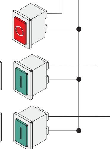
**Ключ-выключатель и/или кнопка частичного открывания (НР контакт)** - Открывание створки для пропуска пешехода (регулируемое посредством триммера PAR.OP.).
