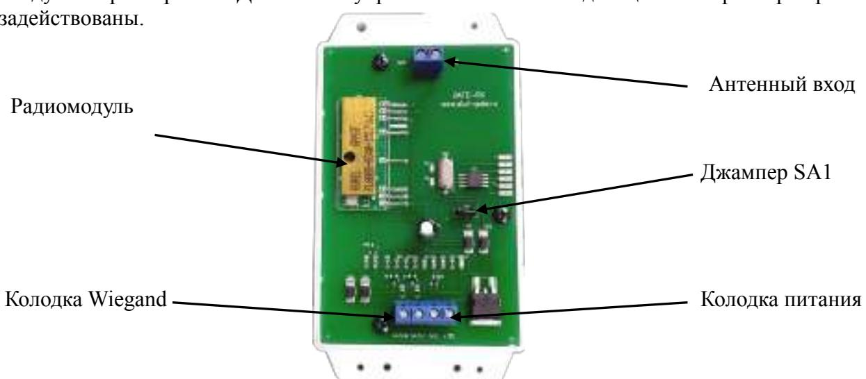
Джампер SA1 определяет характеристику выходов Data0, Data1: положение слева - открытый коллектор; положение справа - имеет нагрузку 10кОм. Штатное положение джампера для работы с контроллером Gate (и аналогичными) — положение справа.
