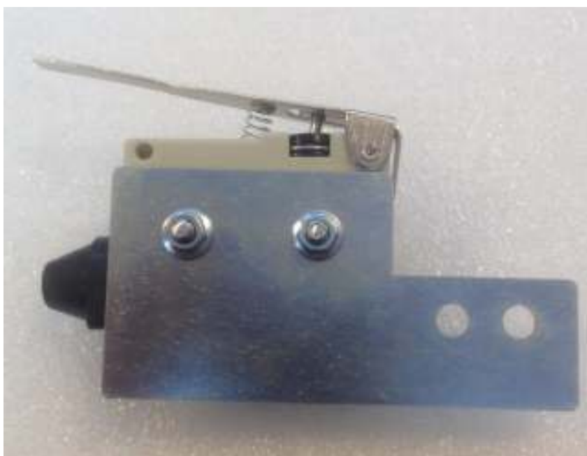
Рис.3.3.7-2 Присоединение датчика вскрытия к монтажной панели
