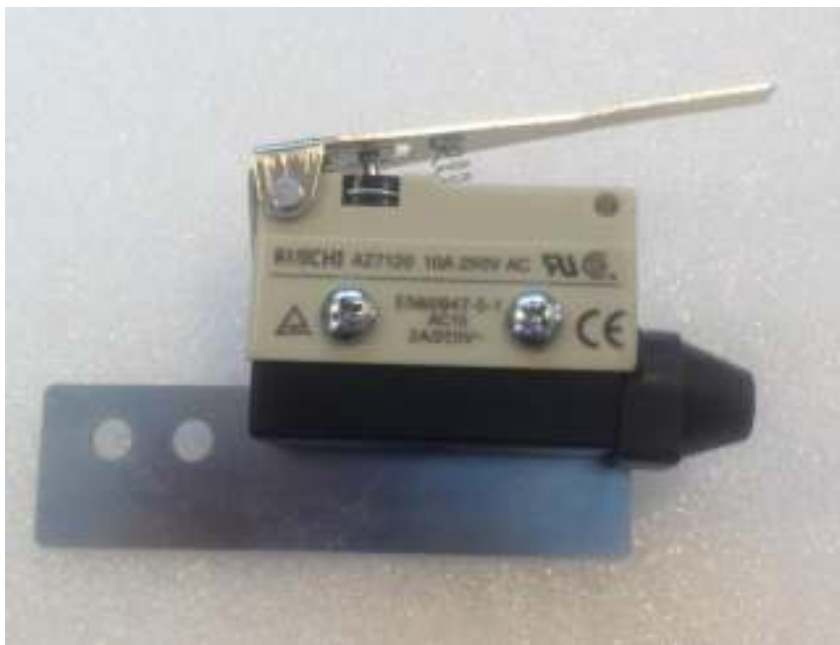
Рис.3.3.7-1 Присоединение датчика вскрытия к монтажной панели
