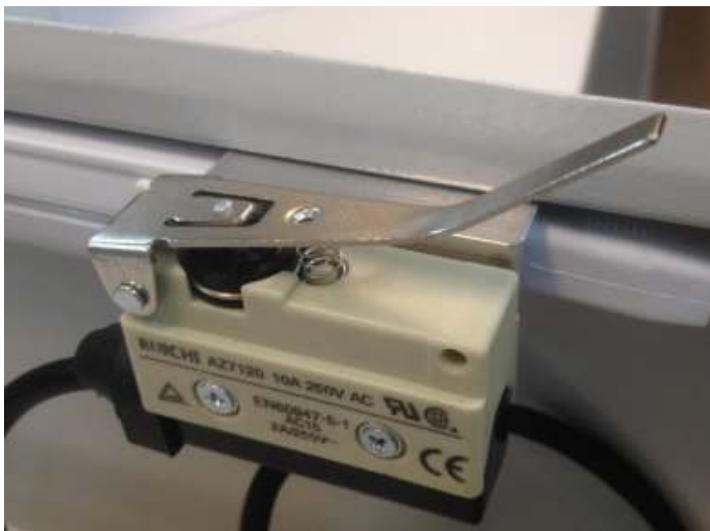
Рис.3.2.10-1 Регулировка положения коромысла выключателя.
