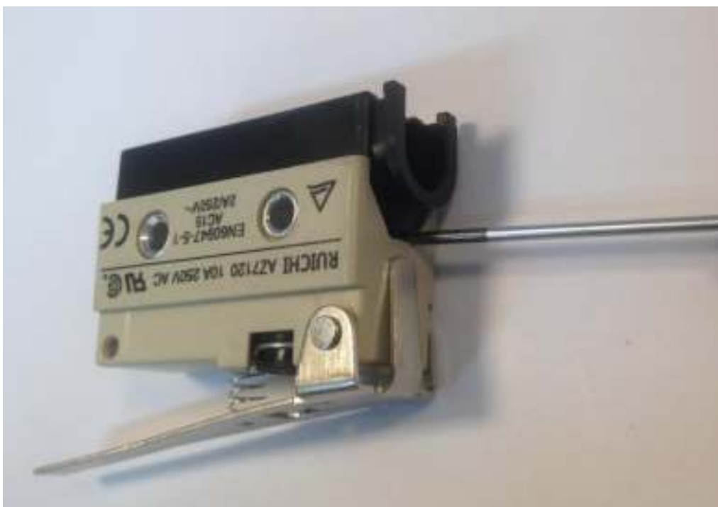
Рис.3.2.3-2 Снятие крышки выключателя
