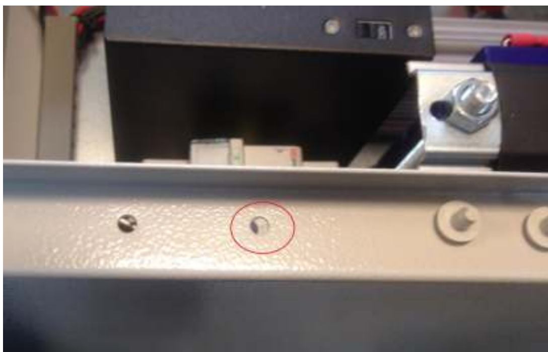
Рис.3.2.8-2 Резиновые заглушки вынуты из отверстий.
