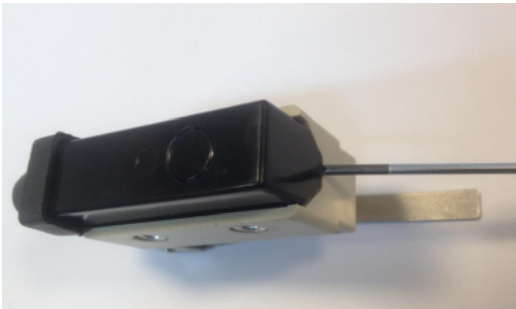
Рис.3.2.3-1 Снятие крышки выключателя
