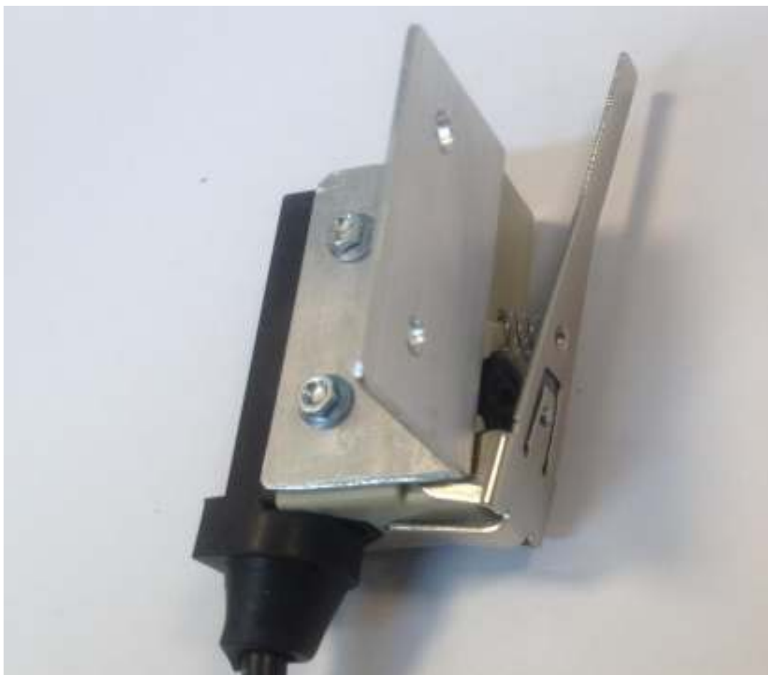
Рис.3.2.7-1 Присоединяем уголок к Датчику вскрытия.
