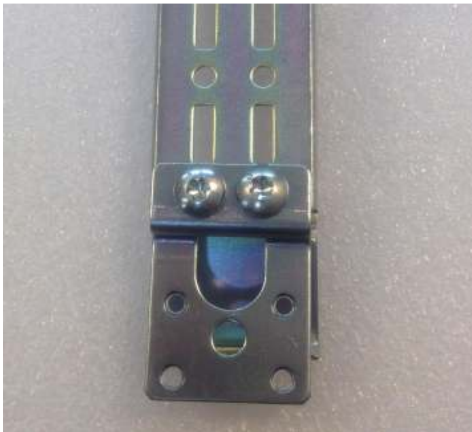
Рис.3.3.8-1 Присоединение удлинителя к шине внутреннего монтажа
