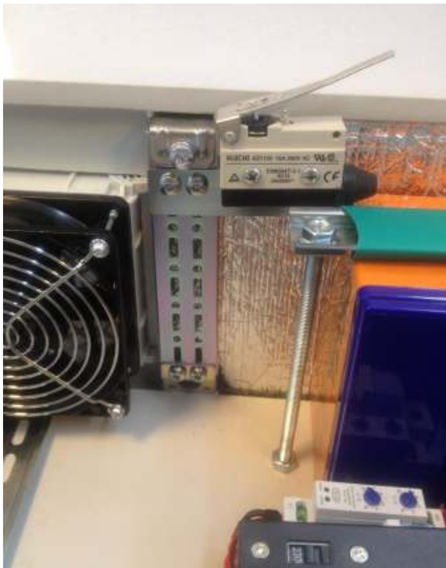
Рис.3.3.10-1 Установленная шина внутреннего монтажа совместно с датчиком вскрытия
