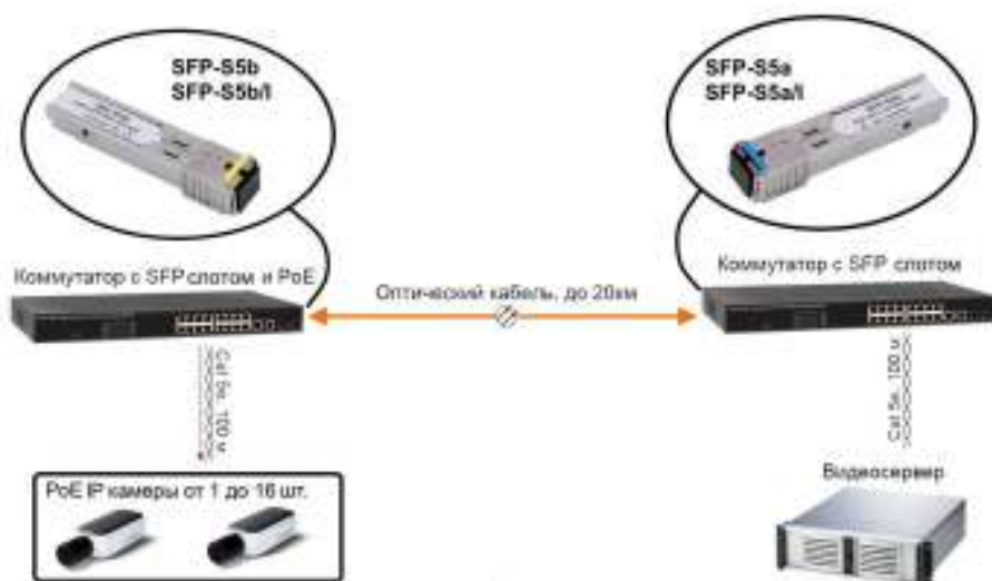
Рис. 4 Схема подключения SFP-модулей
