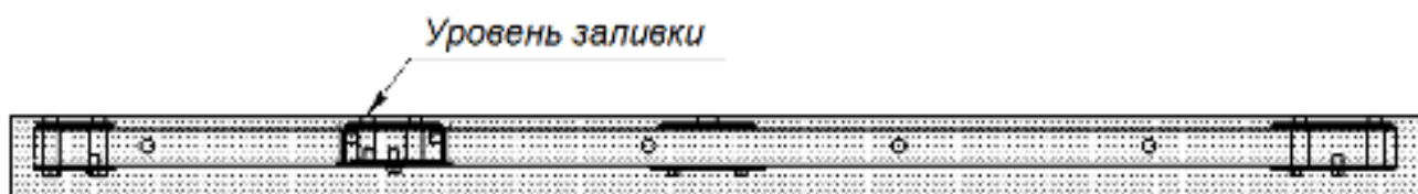
Рисунок 3. Схема установки и заливки рамы
