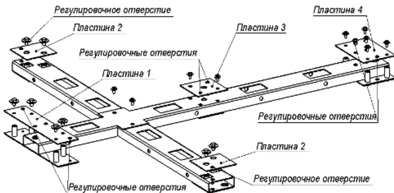
Рисунок 2. Схема сборки рамы.
