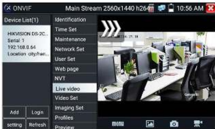
Рис. 33 Управление PTZ IP видеокamerой по ONVIF
