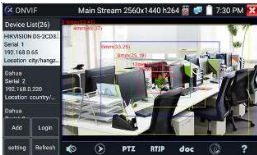
Рис. 54 Функция моделирования угла обзора для разных объективов Lens Simulation
