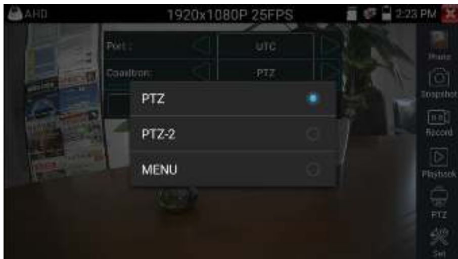
Рис.84 Выбор настроек для управления AHD PTZ видеокамерой по коаксиальному кабелю
