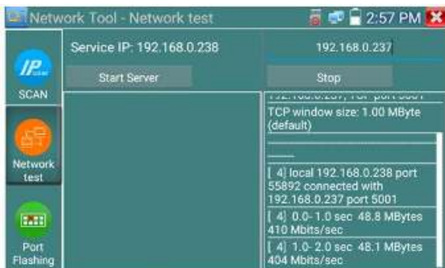
Рис. 89 Работа 2го тестера в режиме «клиент» при проверки пропускной способности сети
