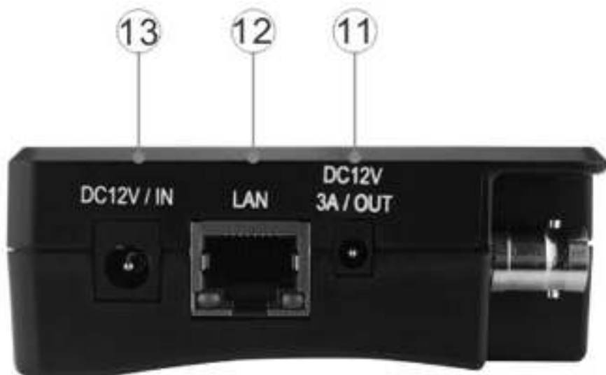
Рис. 5 TIP-H-4(Hand), разъемы, на правой боковой панели
