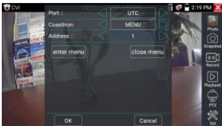
Рис. 78 Настройки для доступа к OSD меню видеокamerы по коаксиальному кабелю
