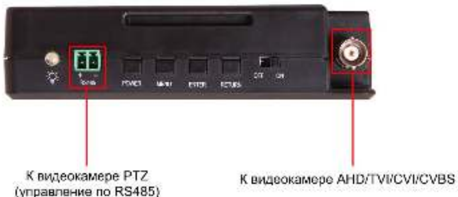
Рис. 11 Подключение AHD/TVI/CVI/CVBS видеокамеры к тестеру
