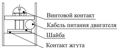
Рисунок 6 – Установка выхода на двигатель.
