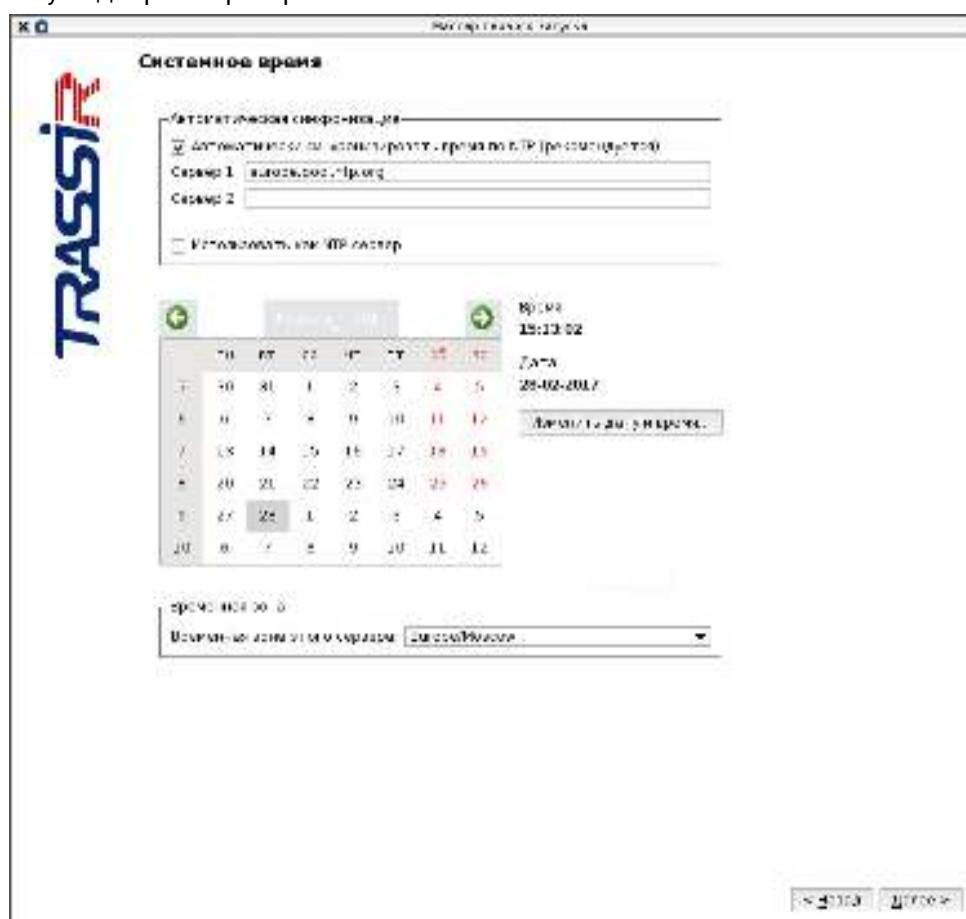
Для автоматической синхронизации времени введите до двух NTP-серверов при этом произойдет попытка синхронизации даты и времени видеорегистратора с одним из NTP-серверов.
