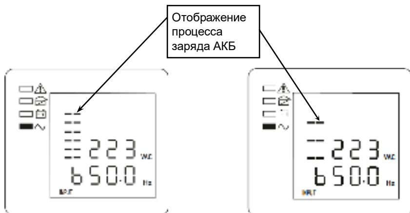
Рисунок 21 — ЖК-дисплей, форсированный (ускоренный) заряд АКБ
