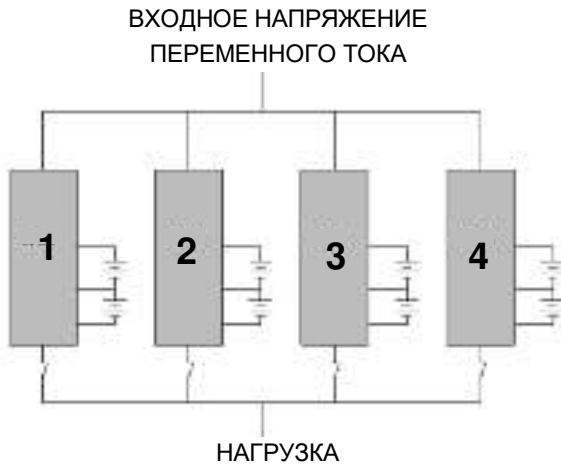
Рисунок 24 — Схема подключения изделий в систему параллельного резервирования.
