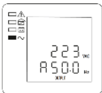
Рисунок 11 — ЖК-дисплей, Фаза А, выходное напряжение и частота
