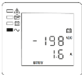
Рисунок 9 — ЖК-дисплей, отрицательная группа АКБ, напряжение и ток
