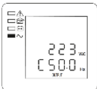
Рисунок 13 — ЖК-дисплей, Фаза С, выходное напряжение и частота
