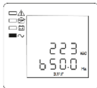
Рисунок 12 — ЖК-дисплей, Фаза В, выходное напряжение и частота
