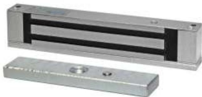
Электромагнитный замок ST-EL150S предназначен для установки на двери, контролируемые СКУД, а также на двери эвакуационных выходов. Небольшие размеры замка обеспечивают его минимальный выступ в дверной проем, благодаря чему снижается общая заметность устройства. Для преодоления остаточной намагниченности в устройстве используется специальное цинковое покрытие якоря замка совместно с пружинным механизмом.
