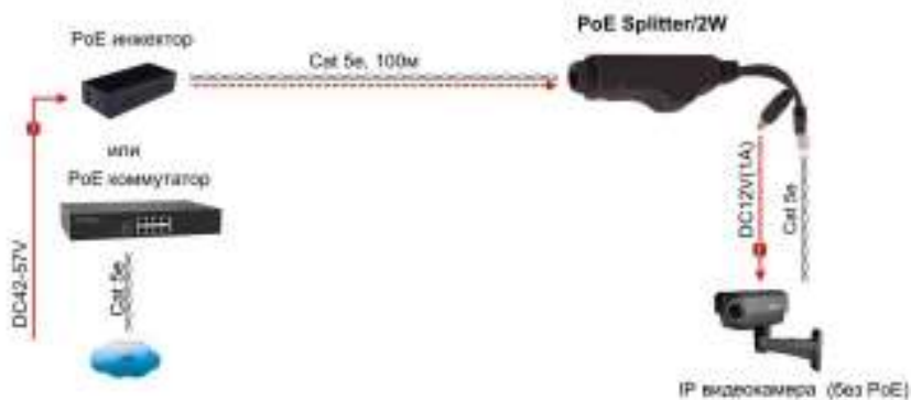
Рис.3 Типовая схема подключения сплиттера PoE Splitter/2W
