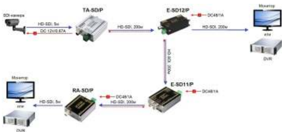
Рис. 9 Схема подключения передатчика TA-SD/P, повторитель-разветвителя E-SD12/P, , повторителя E-SD11/P и приёмника RA-SD/P.
