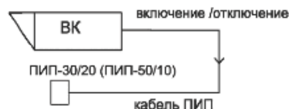
Рис.3 б Включение/выключения ПИП от реле видекамеры
