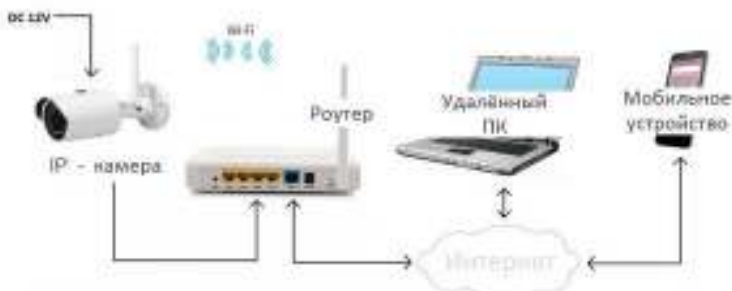
Рис. 2.2 Подключение через роутер
