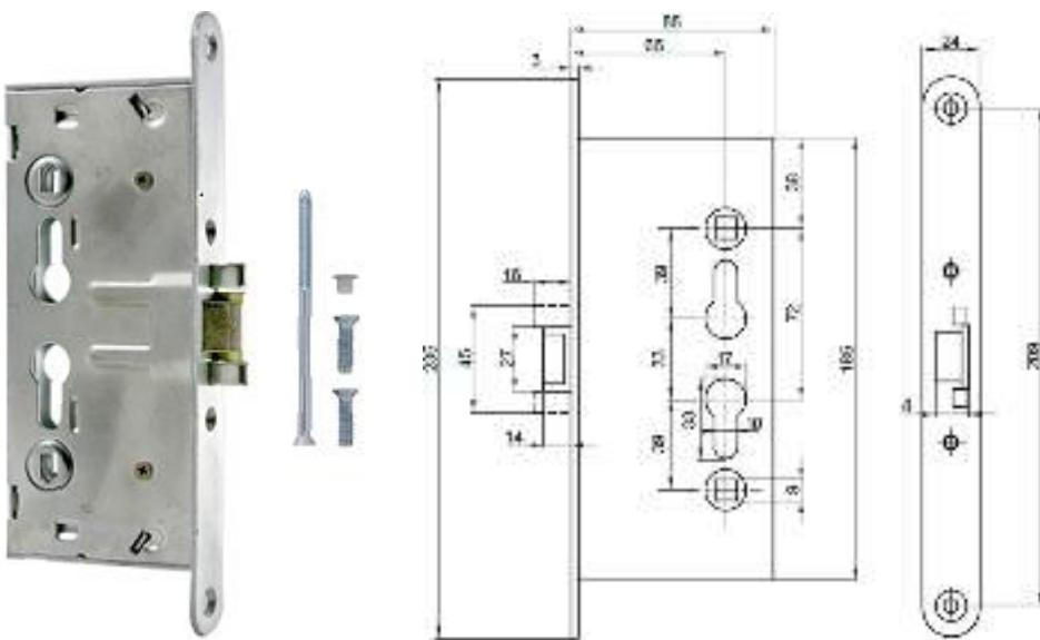
Межосевое расстояние - 72 мм, бэксет - 65 мм, отверстие под ручку – 9 x 9 мм. Покрытие - белый цинк. Винт для крепления цилиндрового механизма - в комплекте. Ручки и цилиндровый механизм в комплект не включены. Функция «антипаника» отсутствует.
