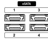
**⚠** Не подключайте и не отключайте устройства eSATA при включенном видеорегистраторе. Для подключения устройства eSATA сначала отключите питание видеорегистратора и отсоедините кабель питания. Подключите устройство eSATA, затем включите его питание, а затем питание видеорегистратора. Для отключения устройства eSATA сначала отключите питание видеорегистратора и отсоедините кабель питания. Выключите устройство eSATA и отсоедините его провод.
