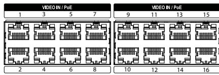
Подключите сетевые камеры и кодировщики видео к видеорегистратору с помощью кабеля RJ-45 (Cat5e или Cat6). Помимо камер и кодировщиков видео вы можете подключать к устройству внешние хабы (например: DH-2112PF, DH-2128PF) и создавать сеть. Распознавание сетевых камер DirectIP™ происходит автоматически. Порты с 1 по 16 поддерживают стандарт PoE (питание по Ethernet).
