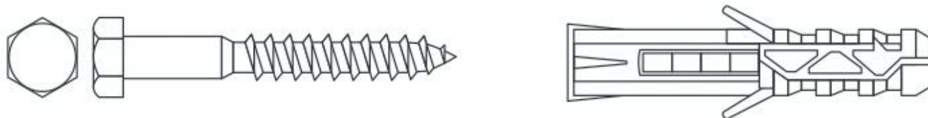
Рисунок 7.4.1 – Шуруп с шестигранной головкой «Глухарь» с дюбелем
