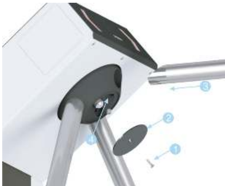
Рисунок 7.5.1 - Установка стандартной преграждающей планки
