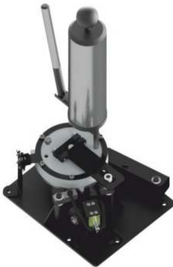
Рисунок 12.3.3 – Доливка демпферной жидкости.
