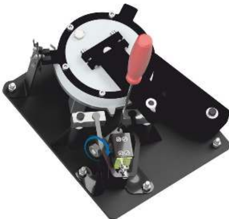
Рисунок 12.4.1 – Регулировка натяжения пружины доводчика
