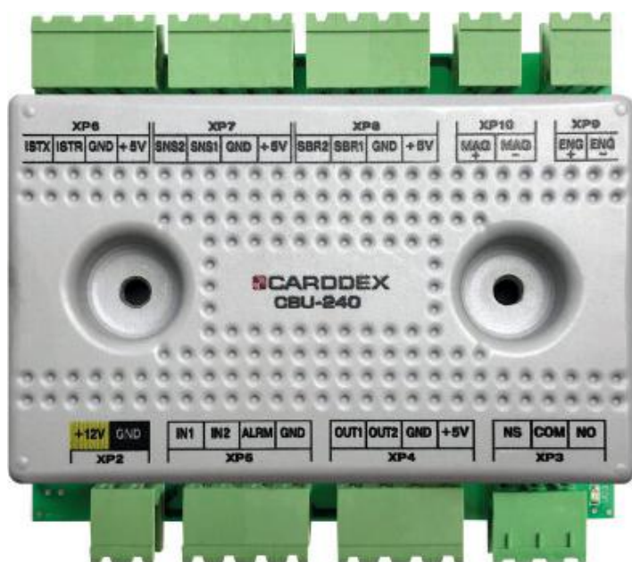
Рисунок 6.3.1 Контроллер управления турникетом «CBU-240»
