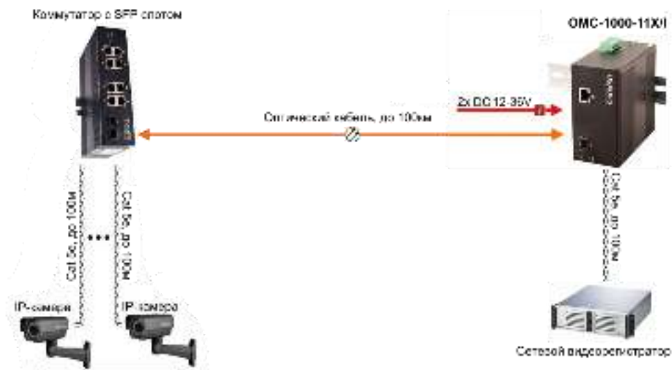
Рис.4 Типовая схема подключения медиаконвертера OMC-1000-11X/I
