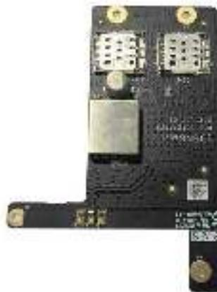
Плата GPRS-связи DS-PM2-G является печатной платой, на которой смонтирован модуль GPRS-связи и другие элементы коммутации и управления для охранной панели AX Hybrid Pro.
