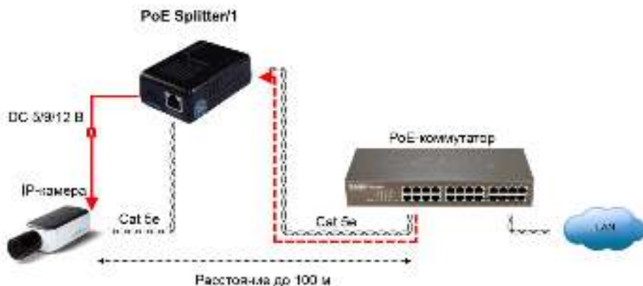
Рис. 4. Схема подключения сплиттера PoE Splitter/1
