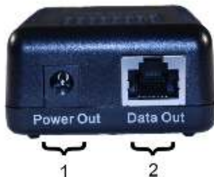
Рис. 2. Сплиттер PoE Splitter/1 , вид спереди
