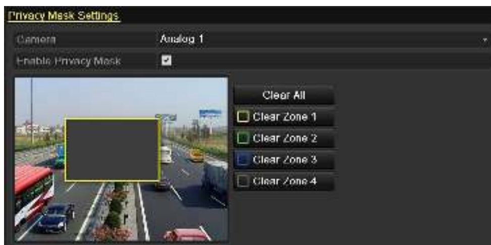
Рисунок 11.4 Установка маски приватности
