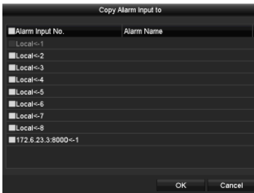
Рисунок 5.24 Настройка тревожных входов
