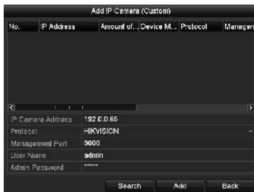
Рисунок 2.13 Ручное добавление камер
