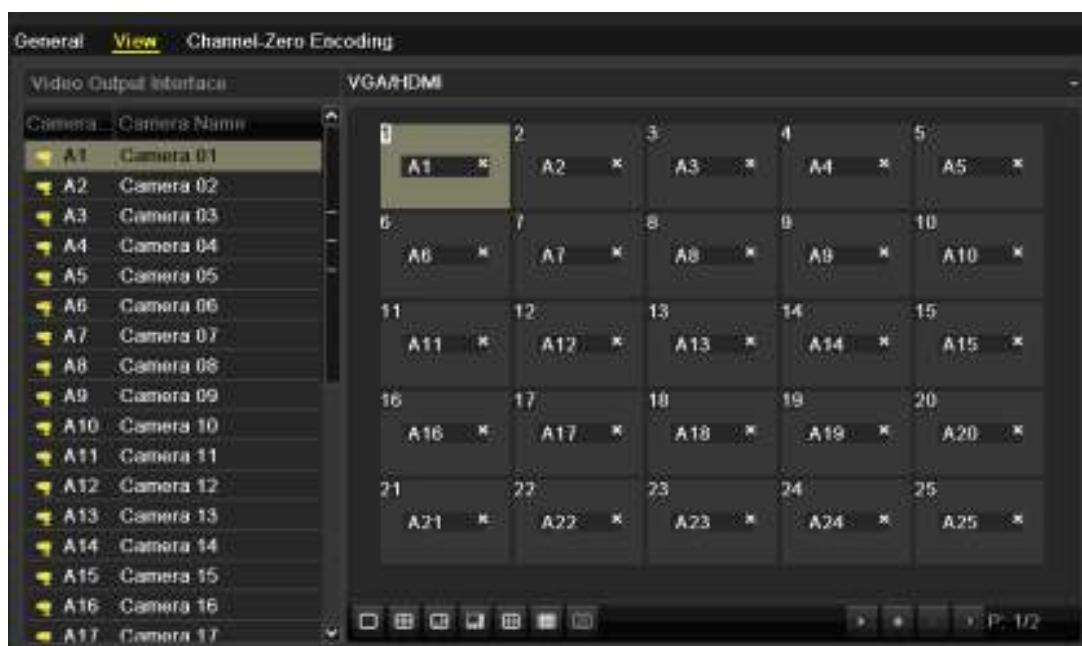
Рисунок 3.8 Отображение – назначение задач камерам
