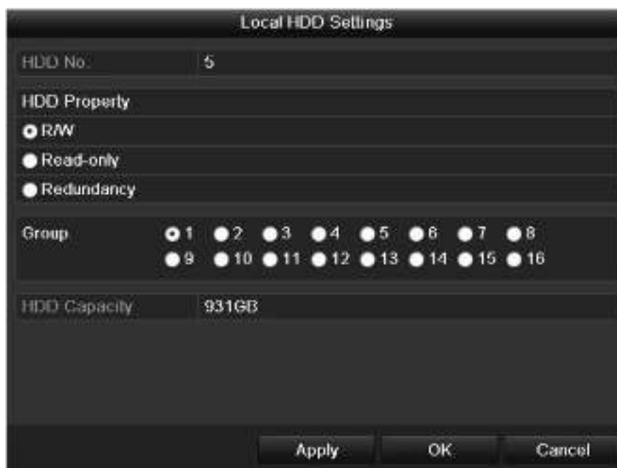
Рисунок 10.13 Установка режима диска
