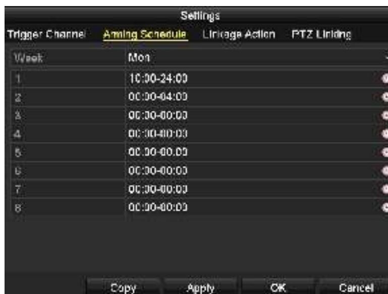
Рисунок 8.9 Установка расписания для входов тревог
