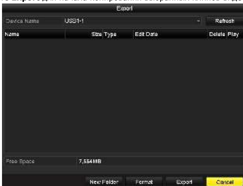
Рисунок 7.14 Экспорт клипов видео с использованием устройства USB
