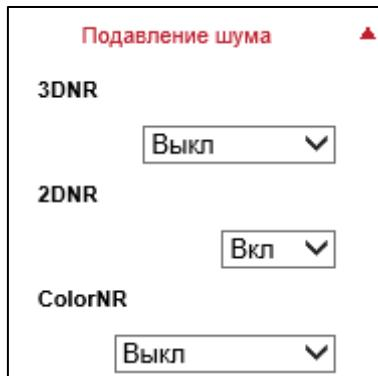
Использование данной функции позволяет снижать уровень шума при низкой освещённости. Фильтр 3DNR рассчитан для сцен со статической картинкой. Фильтр 2DNR используется для фильтрации шумов на сценах с динамической картинкой. Фильтр ColorNR используется для подавления цветовых шумов.
