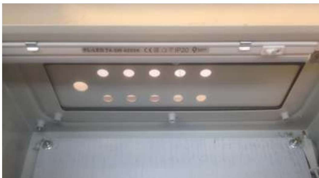
Рис.3.1.5-1 Установка светильника в корпус.
