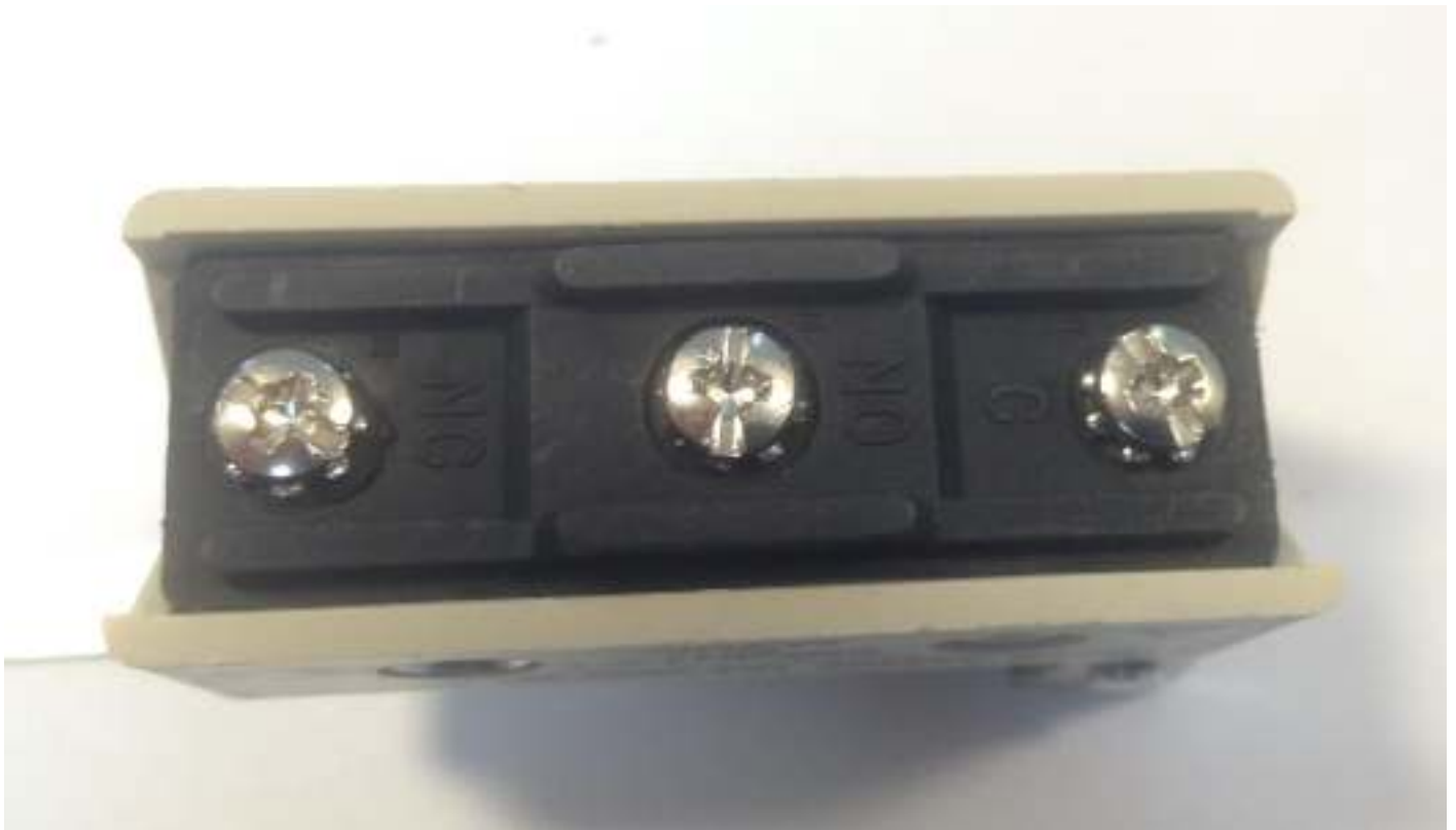
Рис.3.3.5-1 Контакты Датчика вскрытия
