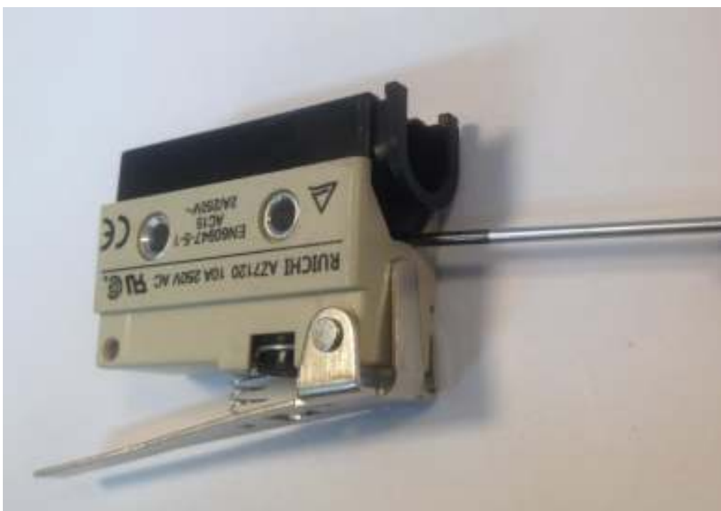
Рис.3.3.3-2 Снятие крышки выключателя
