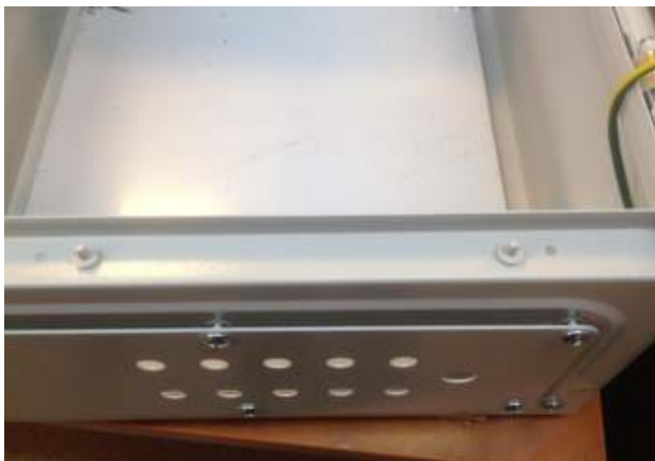
Рис.3.1.2-2 Резиновые заглушки вынуты из отверстий OS.
