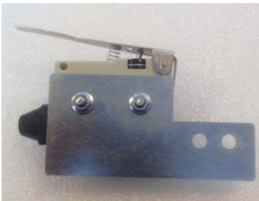
Рис.3.4.7-2 Присоединение датчика вскрытия к монтажной панели
