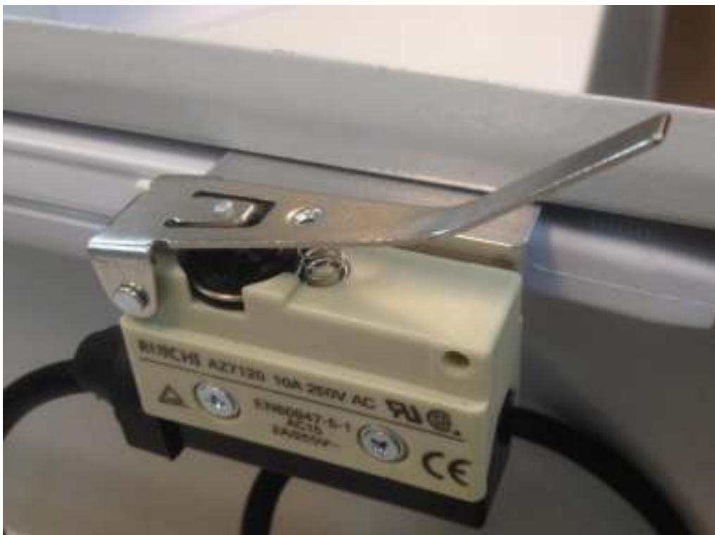
Рис.3.3.10-1 Регулировка положения коромысла выключателя.
