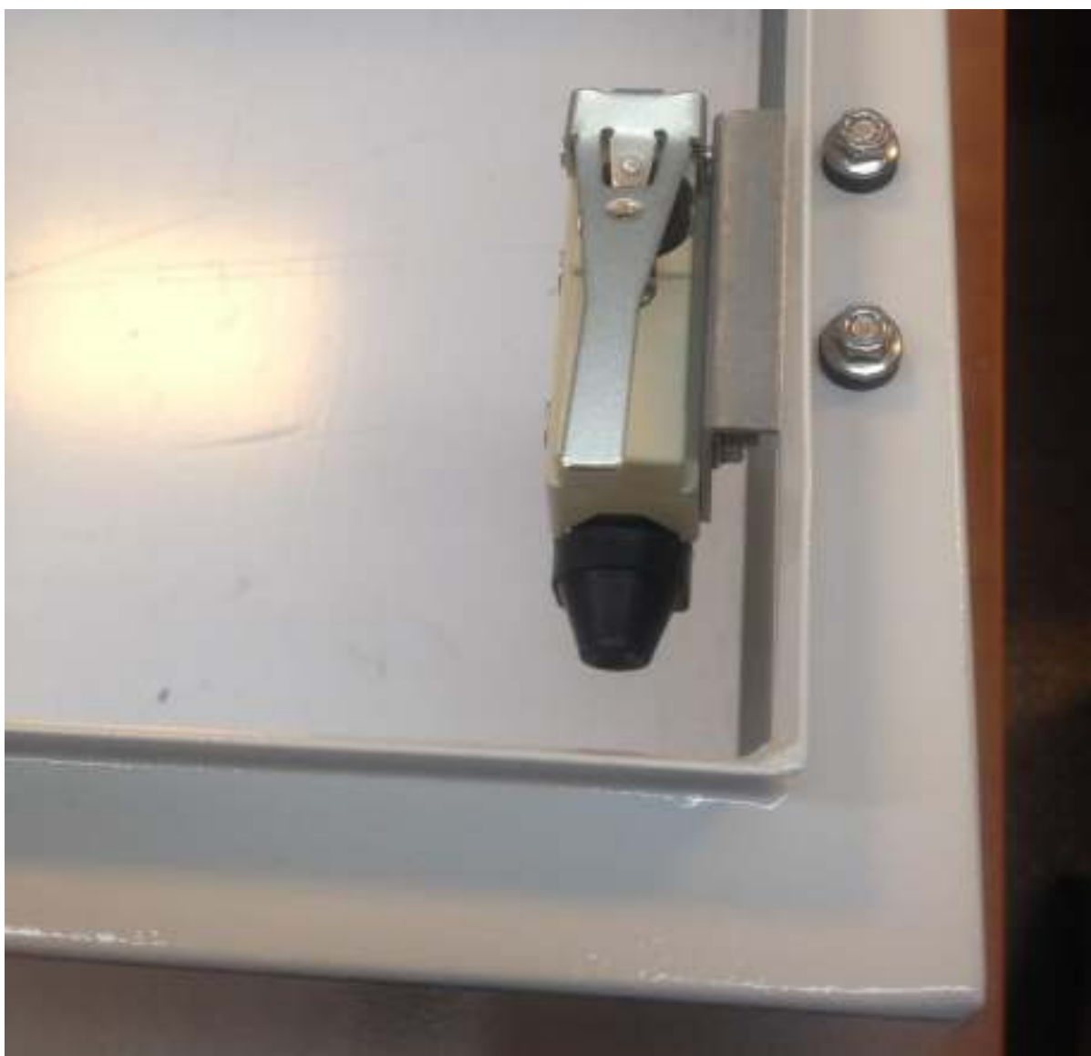
Рис.3.3.9.-1 Установленный выключатель вскрытия.
