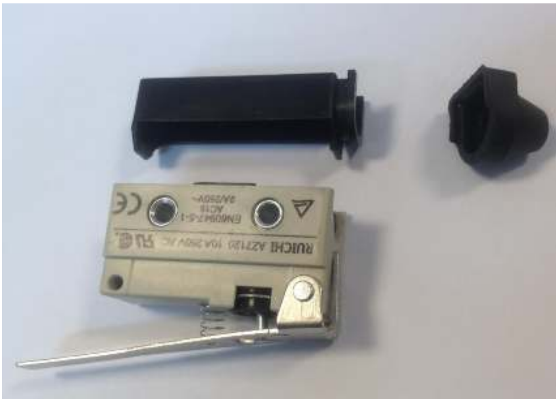
Рис.3.3.4.-1 Снятие крышки выключателя
