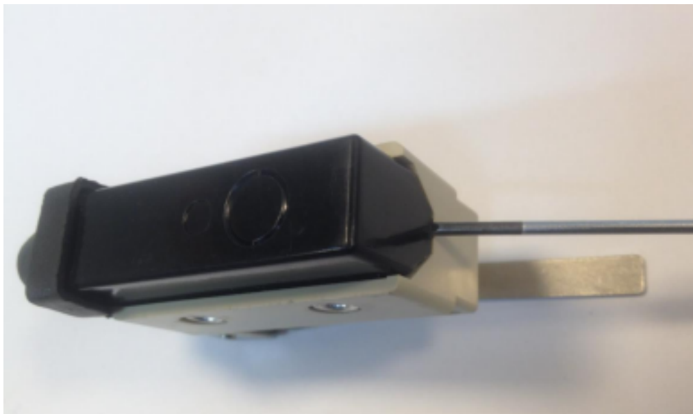
Рис.3.3.3-1 Снятие крышки выключателя
