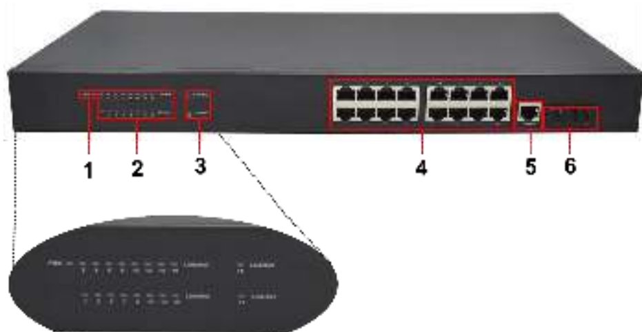
Рис. 6 Коммутатор SW-71602/L2, разъемы и индикаторы на передней панели
