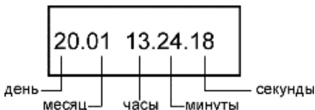
Рисунок 3.4. Пример экрана пульта при нажатии клавиши «0»
