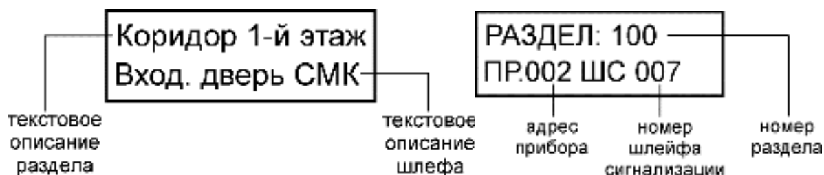
Рисунок 3.6. Примеры экрана пульта при нажатии клавиши «2»
