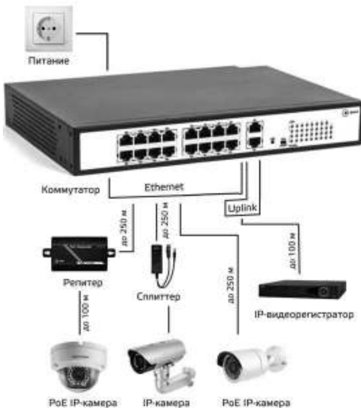
Рисунок 3 – Общая схема подключения устройств к коммутатору
