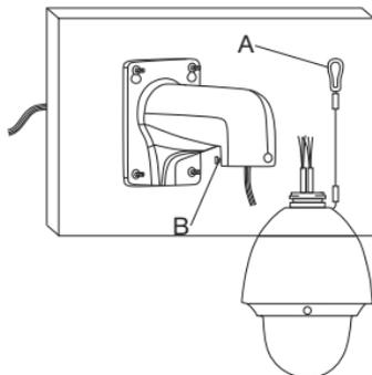
4. Закрепите скоростную поворотную камеру на кронштейне с помощью фиксирующих винтов.
