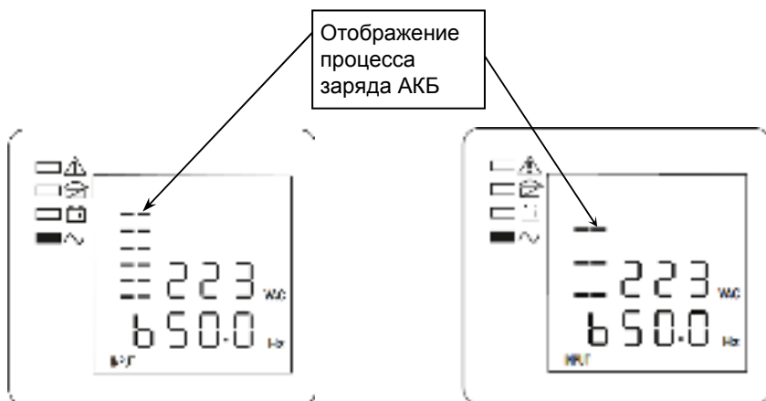
Рисунок 21 — ЖК-дисплей, форсированный (ускоренный) заряд АКБ
