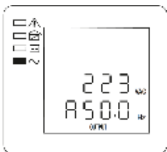
Рисунок 11 — ЖК-дисплей, Фаза А, выходное напряжение и частота
