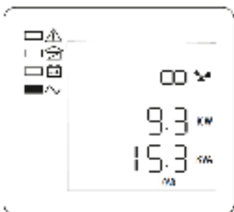
Рисунок 17 — ЖК-дисплей, общая мощность нагрузки
