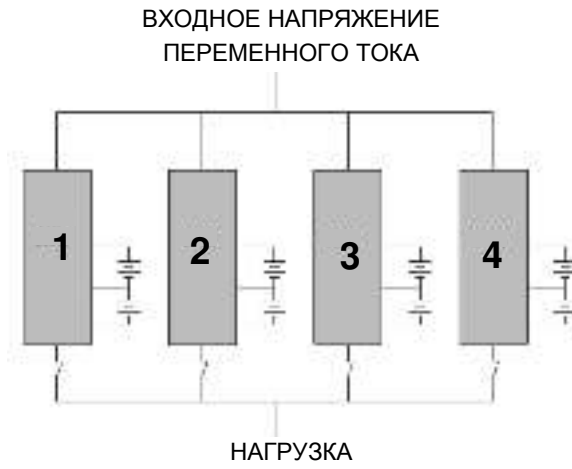
Рисунок 24 — Схема подключения изделий в систему параллельного резервирования.
