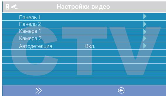
Параметры «Панель1», «Панель2», «Камера1» и «Камера2» используются для указания стандарта, разрешения и формата видеосигнала по выбранному каналу. Выберите нужный канал и нажмите на кнопку «Меню», после чего откроется окно:
