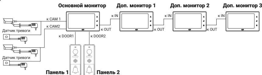
Монитор разработан для работы с одной или двумя вызывными панелями. Вызывные панели подключаются только к основному монитору.
