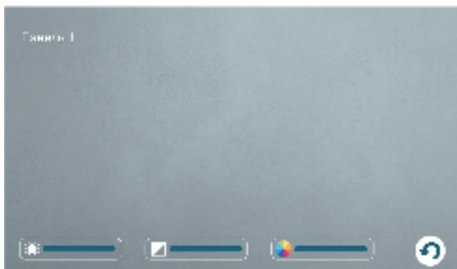
В нижней части окна доступны параметры регулировки яркости, контраста и цветности. Поворачивайте кнопку-колесо «Меню» для выбора нужного параметра изображения – яркости, контраста или цвета. Нажмите на кнопку-колесо для подтверждения выбора, а затем поворачивайте колесо вверх или вниз для изменения значения. Диапазон значений шкалы регулировки: 0-50, значение по умолчанию: 25.
