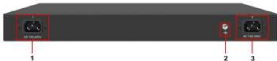
Рис. 3 Коммутатор SW-48G4X-1L, разъемы на задней панели
