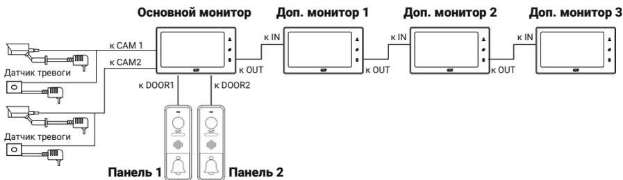
Вызывные панели подключаются только к основному монитору.
