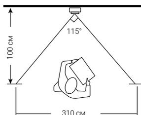
Угол обзора по горизонтали составляет  $115^\circ$ , по вертикали –  $63^\circ$ , что позволяет обеспечить зону наблюдения шириной 310 см и высотой 122 см на расстоянии 100 см от панели.
