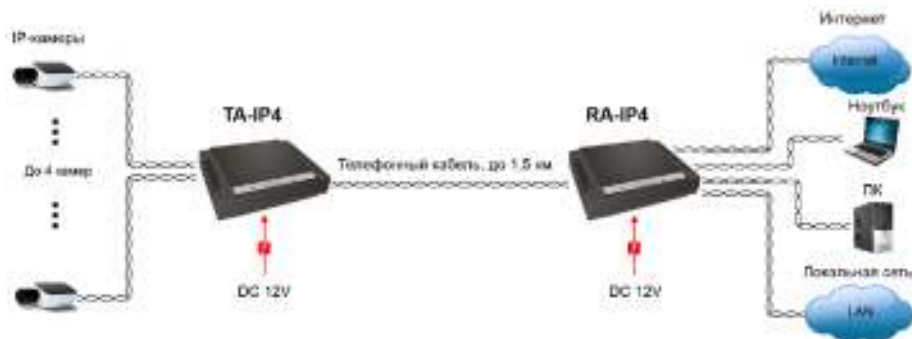
Рис. 5 Схема соединения удлинителей RA-IP4/TA-IP4
