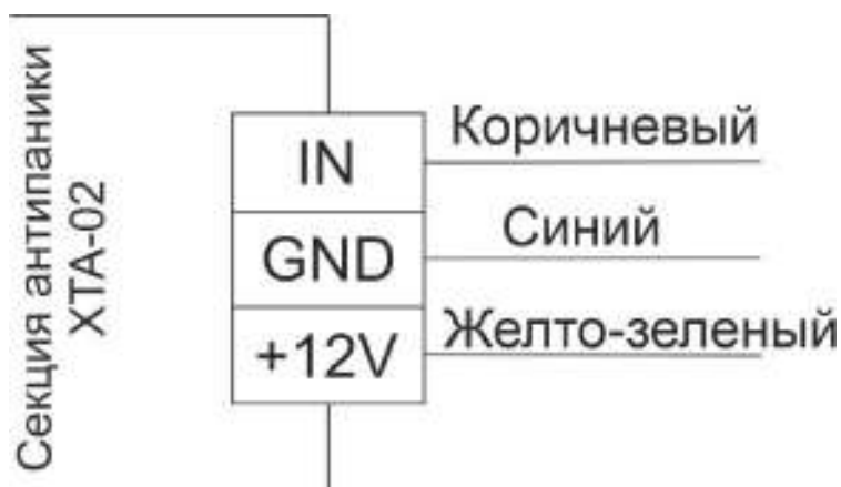
Рисунок 8.1 Назначение проводов секции Антипаника «ХТА-02»
