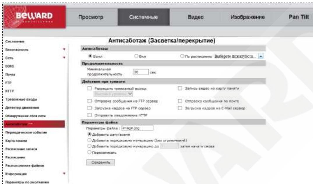
Под вмешательством понимаются действия, направленные на изменение направления наблюдения, закрытие объектива камеры предметом, засветка объектива камеры и т.п. Обнаружение вмешательства происходит благодаря анализу видеоизображения за заданный период времени.
