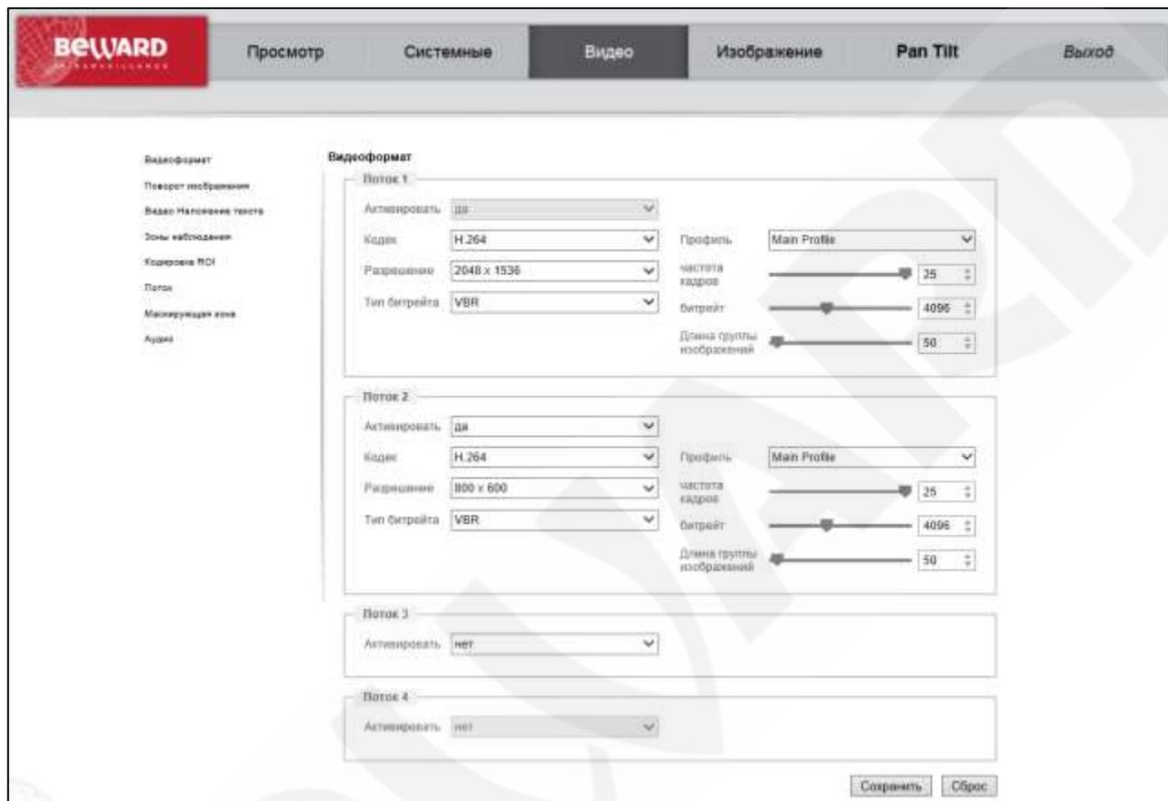
**Кодек (Encode Type):** В качестве форматов кодирования могут быть выбраны MJPEG, H.264 и H.265.
