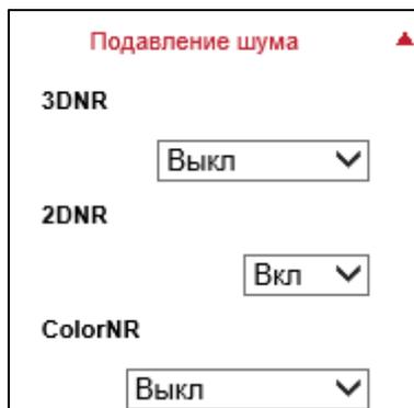
Использование данной функции позволяет снижать уровень шума при низкой освещённости. Фильтр 3DNR рассчитан для сцен со статической картинкой. Фильтр 2DNR используется для фильтрации шумов на сценах с динамической картинкой. Фильтр ColorNR используется для подавления цветowych шумов.
