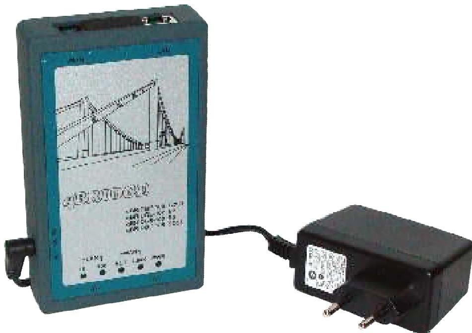
**Индикаторы:** Светодиодные индикаторы отображают состояние устройства qBRIDGE.
