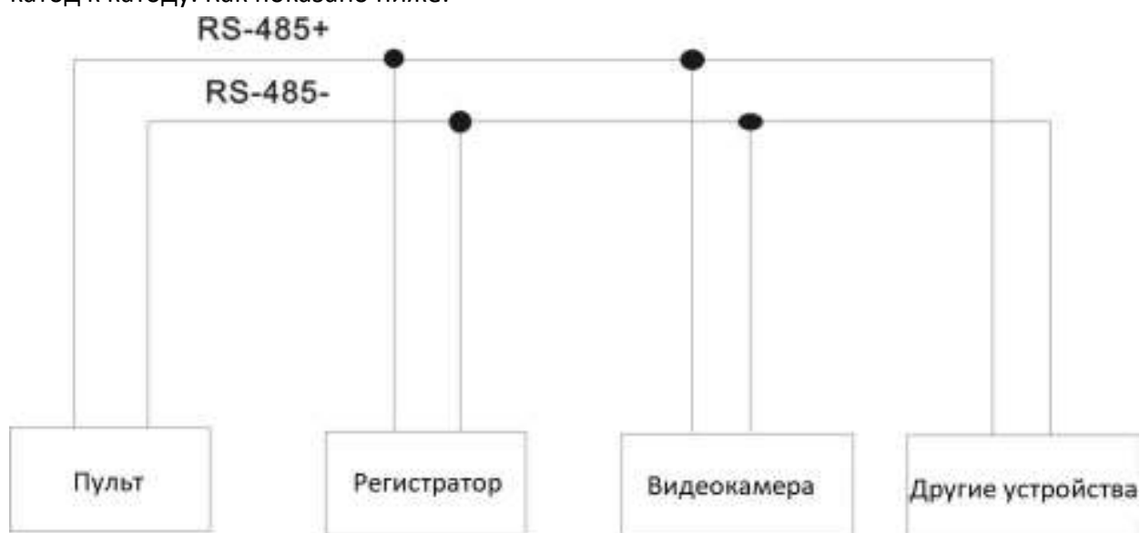
Схема подключения нескольких PTZ камер:
