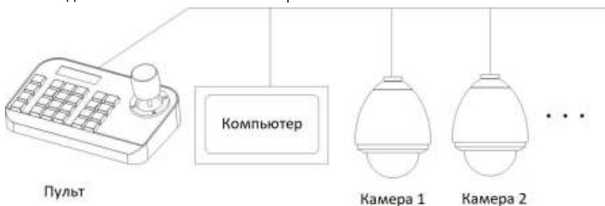
Схема подключения нескольких PTZ камер:
