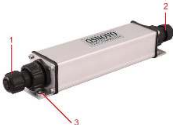
Рис.2 Удлинитель E-PoE/2W, E-PoE/2GW. (А) –в разобранном виде. Б)разъемы подключения
