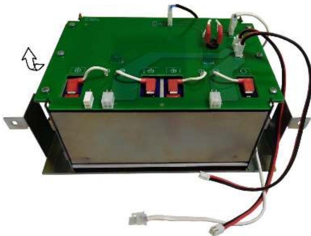
Рисунок 7.6 – Отсек с установленными АКБ.
