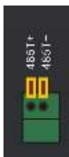
RS485 интерфейс 4 канального регистратора
