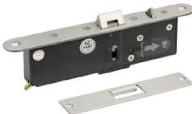
Электромеханический замок ST-DB650M предназначен для работы в составе систем контроля доступа с электронным управлением запирающим устройством. Замок ST-DB650M является универсальным, т.е. может работать как нормально-закрытый, так и как нормально-открытый. В нормально-закрытом режиме замок разблокируется при подаче питания и блокируется при отключении, а в нормально-открытом режиме разблокируется при отключении питания и блокируется при подаче.
