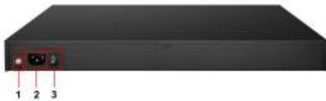
Рис.6 Коммутатор SW-48G4X-2L, разъемы и кнопки на задней панели
