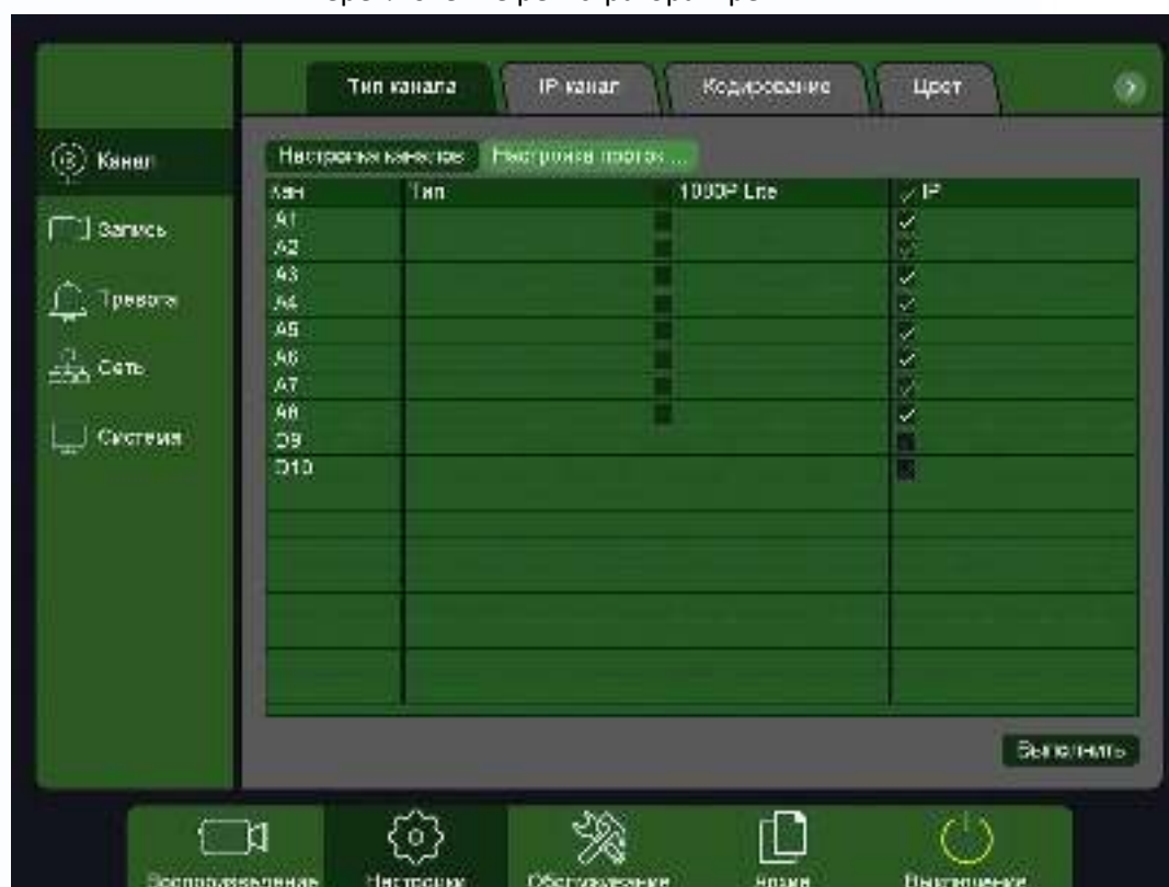
Переключение регистратора в режим NVR:
