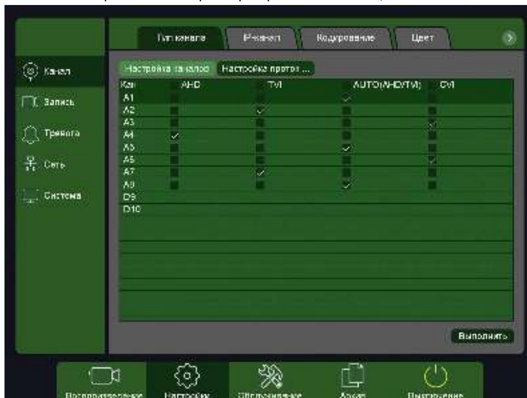
Настройка каналов регистратора TSr-UV0811 Eco, UV0812 Eco:
