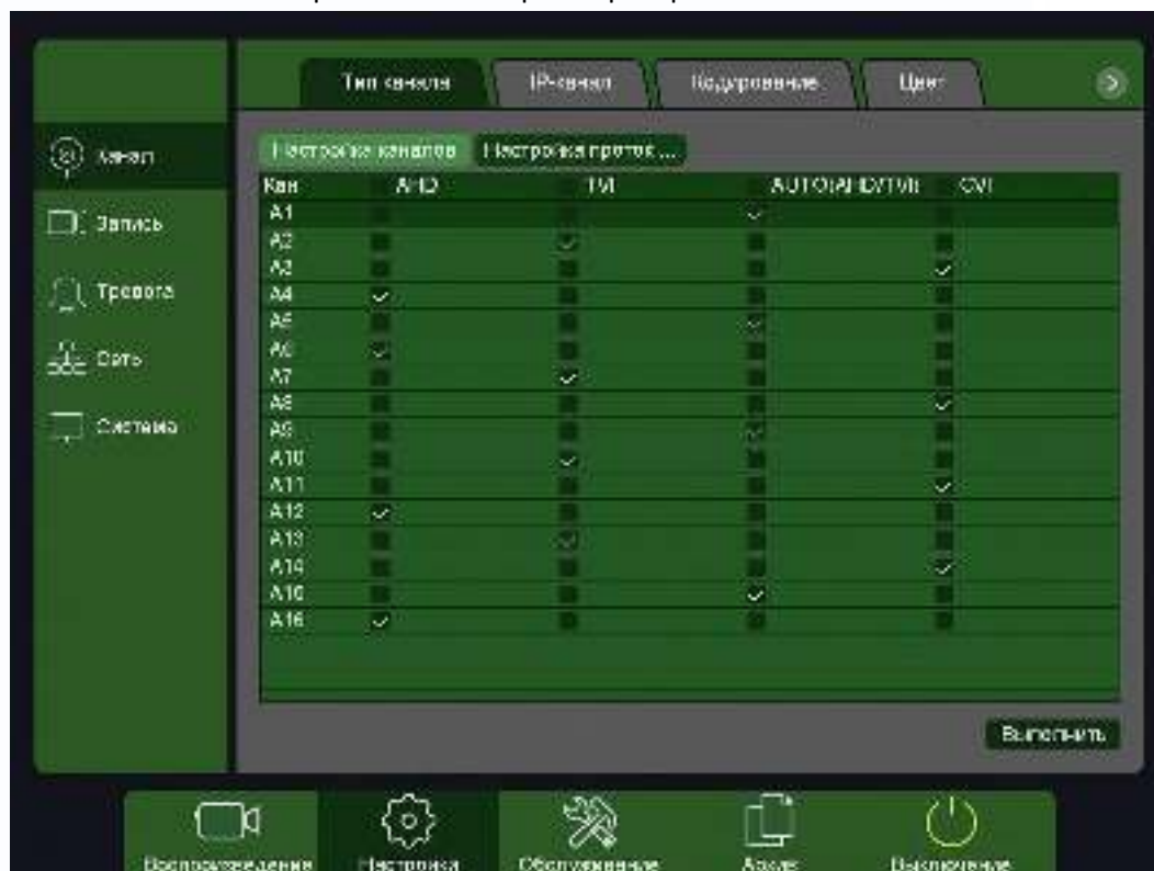
Настройка каналов регистратора TSr-UV1622 Eco:
