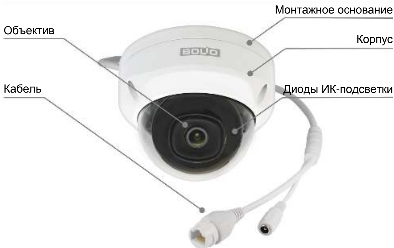
Рисунок 4.1 — Внешний вид и основные элементы видеокамеры
